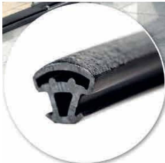
Bei der neuen Gleitdichtung sorgt die intelligente Kombination von EPDM und TPE für hohe Dichtigkeit bei einem drastisch reduzierten Reibwiderstand.
